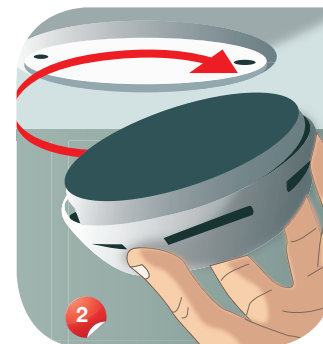
2. Assembler le détecteur sur sa plaque de montage
